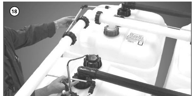
Zamontować wcześniej przygotowany kolektor poboru paliwa.
