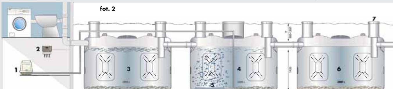
1. KOMPRESOR 2. MICRO-STEP UNIT 3. OSADNIK WSTĘPNY 4. OSADNIK MICRO-STEP 5. NAPONIEWIETRZACZ 6. OSADNIK KOŃCOWY 7. STUDZIENKA
