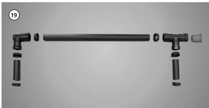
Zmontować kolektor odpowietrzenia;
